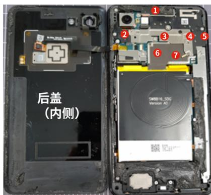
图9：取下后盖的谷歌Pixel 3XL。如图所示，七个位置的现有气隙厚度通过适形聚合物测量得出。
